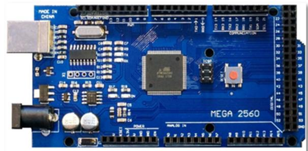
Fig. 3 Arduino MEGA 2560
