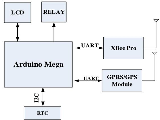
Fig. 6 Block diagram data logger module
