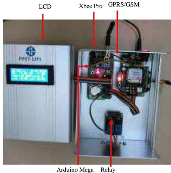
Fig. 7 Data logger module
