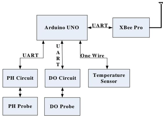
Fig. 4 Sensor module
