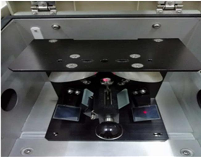
Fig. 2 FTIR Interferometer
