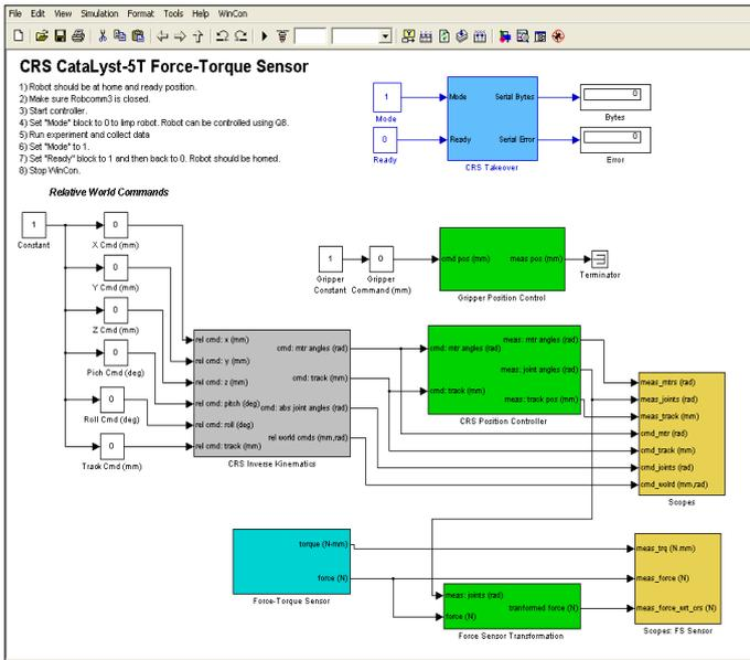
Fig. 3 Simulink model
