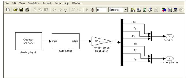
Fig. 4 Force-Torque Sensor subsystem
